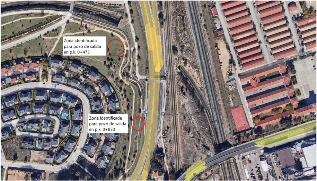
Figura 24 – Posibles zonas identificadas para la localización de los pozos de salida de emergencia en los tramos de túnele en mina, galerías en mina conectarán el túnel con el pozo de salida.
